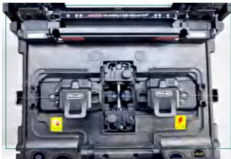
注意：请勿沿着 V 型槽滑动光纤。光纤切面应超出 V 槽位置，但不应超过电极棒尖端位置。（如图）
