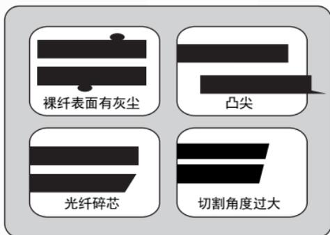
注：光纤检查是自动进行的，按下熔接按钮，熔接机会自动聚焦并检查光纤是否有损伤或灰尘颗粒。
