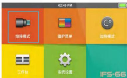
注意：熔接机出厂时设置为“自动熔接”，当关闭防风盖时便开始熔接。
