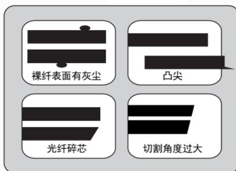
注：光纤检查是自动进行的，按下熔接按钮，熔接机会自动聚焦并检查光纤是否有损伤或灰尘颗粒。
